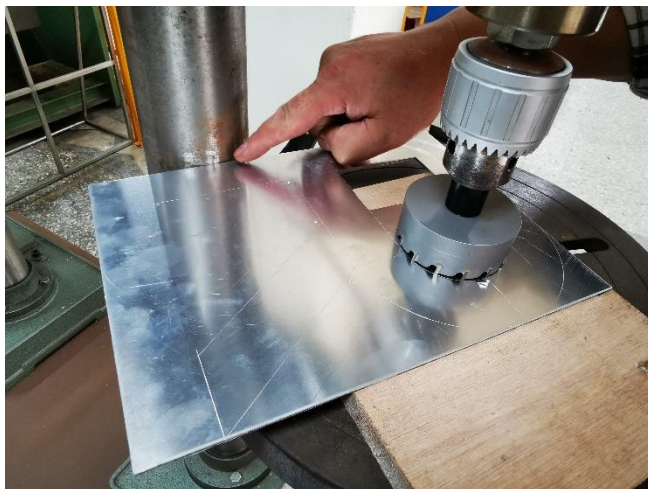
材料需靠緊梁柱
