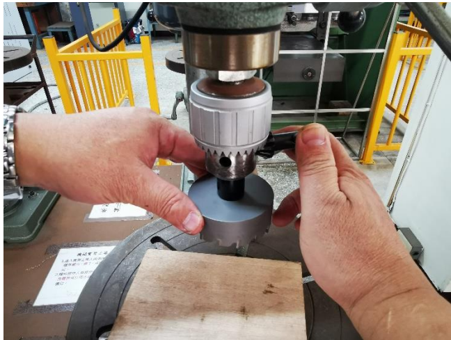
安裝 \varnothing 70\text{mm} 圓穴鋸
