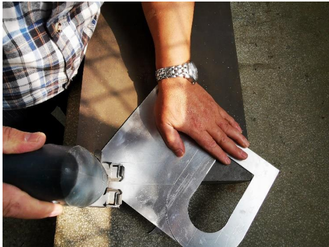
手電鋸切外斜線
